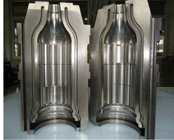
Cam kalıpları ve parçaları (Paslanmaz çelikler, 1.2080, vs.)
